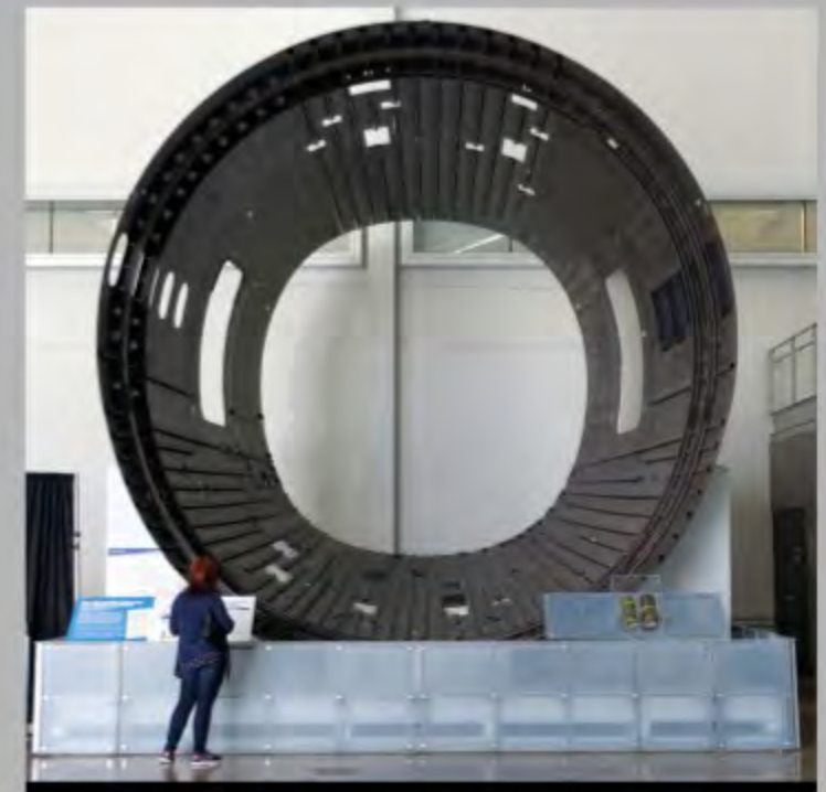
Tronçon de fuselage en carbone (prototype)
